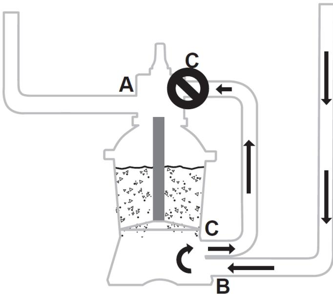
Um zu verhindern, dass Wasser austritt, setzen Sie die **Kappe für Anschluss D (M)** auf den Anschluss D und sichern Sie die Verbindung mit einer **Schlauchklemme (N)**, bevor Sie die Sandfilteranlage in Betrieb nehmen. Wenn das 6-Wege-Ventil auf die Funktionen **Rückspülen**, **Spülen** oder **Entleeren** eingestellt ist, öffnen Sie die **Schlauchklemme (N)** und entfernen Sie die **Kappe für Anschluss D (M)**, damit das Wasser aus dem Anschluss D ablaufen kann.
