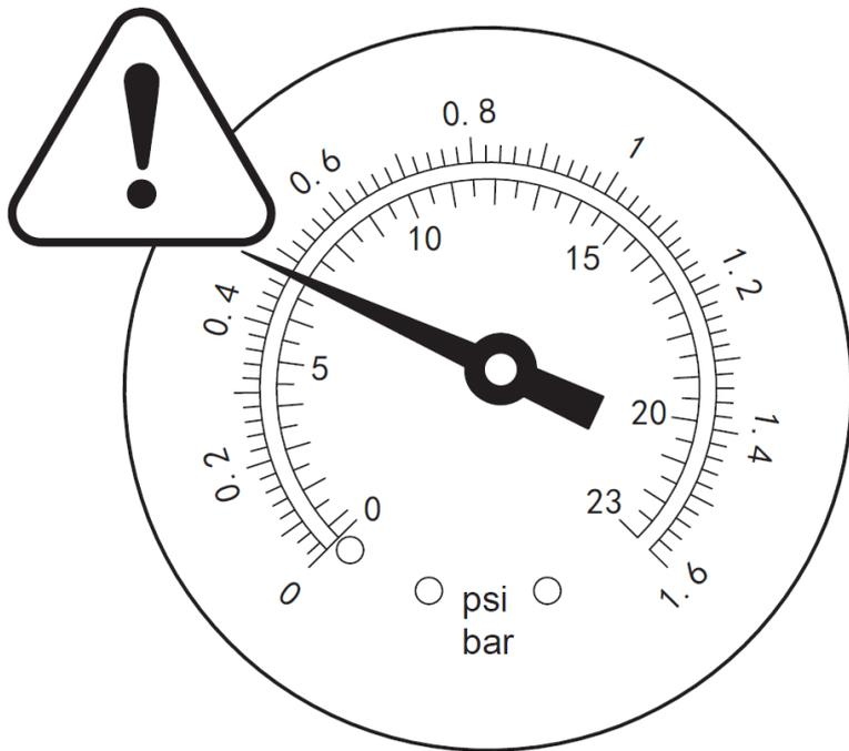
**HINWEIS:** Das Manometer dient nur zu Wartungszwecken, und der Wert des Manometers dient nur als Referenz. Es sollte nicht als Präzisionsinstrument verwendet werden.
