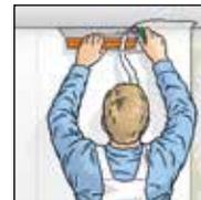
**8.** In den Ecken wird die Trennung mit dem Tapezierspachtel und einem Cuttermesser oder mit einer Schere ausgeführt.
