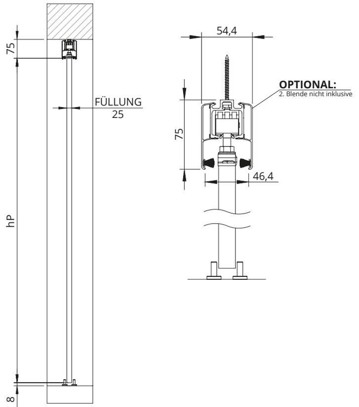
2 Jetzt können die oberen Rollen und die Positionsstopper in die obere Laufschiene geschoben werden.
