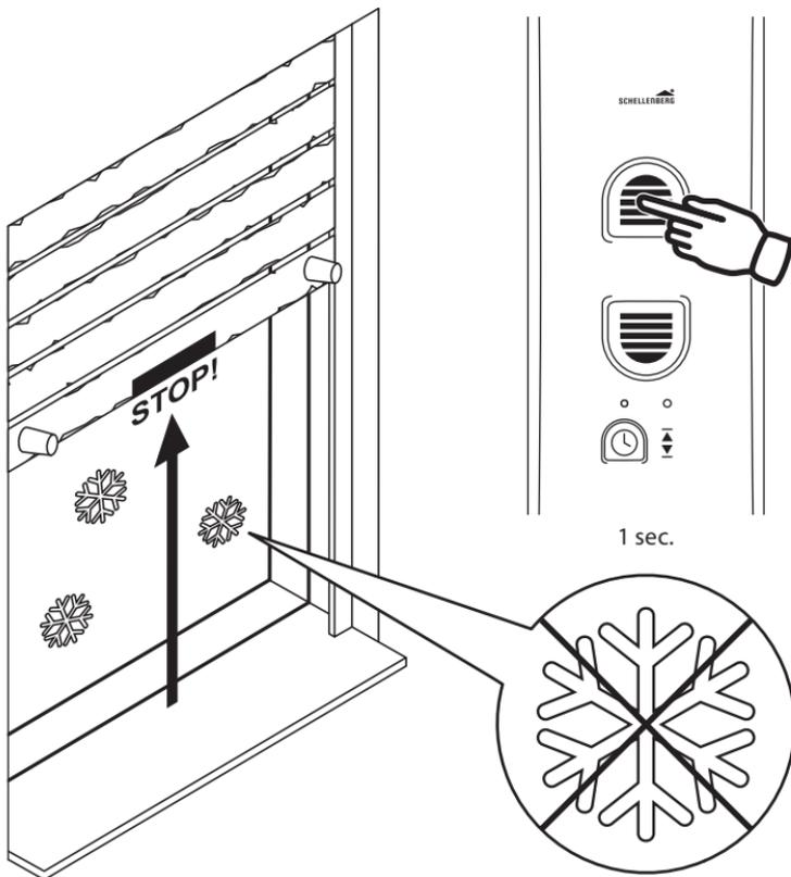
Blockiert der Rolladen während der Auffahrt (z.B. durch Vereisung), schaltet das Produkt ab. Beseitigen Sie die Überlastungsursache.
