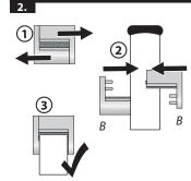
Die Bürstendichtung auseinanderziehen. Den Gurt zwischen den Bürsten nach vorne einfädeln und die Dichtung wieder zusammenstecken.
