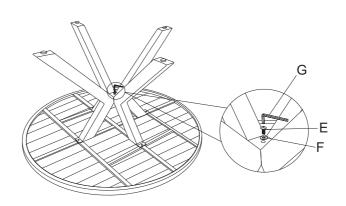
Verschrauben Sie die Tischbeine (B und C) miteinander. Verwenden Sie hierfür die Schraube (E), eine Unterlegscheibe (F) und den Inbusschlüssel (G).
