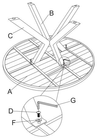
Schrauben Sie die Tischbeine (B und C) mithilfe der Schrauben (D) und Unterlegscheiben (F) an der Tischplatte (A) fest. Verwenden Sie zum Festziehen der Schrauben den beiliegenden Inbussschlüssel (G).
