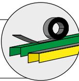
**5.** Weitere Knauf CW-dB-Ständerprofile im entsprechenden Achsabstand (siehe Tabelle) in die Knauf UW-dB-Rahmenprofile einstellen. Knauf CW-dB-Ständerprofile sollten ca. 1,5 cm kürzer sein als das lichte Raummaß und jeweils mind. 1,5 cm in das Knauf UW-dB-Profil eingreifen. Im Türbereich Knauf UA-Aussteifungsprofile in Verbindung mit Knauf Türpfostensteckwinkeln verwenden.
