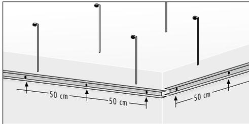
**3.** **Knauf Ankerfix-Schnellabhänger** **A** in **Draht mit Öse** einfädeln. In das **Knauf CD-Profil** eindrehen und über das **Knauf UD-Wandprofil** fluchtgerecht ausrichten. Anschließend den Splint einklicken.
