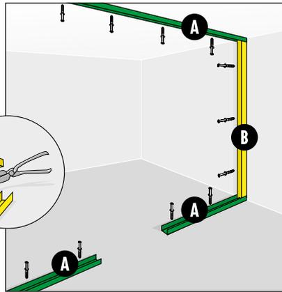
**3.** Knauf Dichtungsbund auf die Knauf UW-dB-Rahmenprofile **A** (Decke und Boden) und Knauf CW-dB-Ständerprofile **B** (Wand) kleben.
