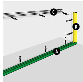
**4.** **Knauf CW-dB-Ständerprofile** im entsprechenden Achsabstand (s. Tabelle) in oberes und unteres **Knauf UW-dB-Profil** einstellen. Im Bereich der Sanitäreinbauteile **Knauf UA-Aussteifungsprofile** verwenden und diese im Bodenbereich mit **Knauf Türpfostensteckwinkeln** befestigen.
