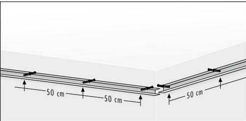
**2.** **Knauf Draht mit Öse** (oder alternativ **Knauf Direktabhänger**) im Achsabstand von max. 90 cm an Rohdecke befestigen (bei Holzbalken Flachkopfschrauben, bei Stahlbetondecke **Knauf Deckennagel** verwenden), Öse umknicken.
