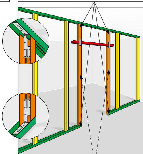
**TIPP** Wenn die Wand niedriger als 2,60 m, die Türbreite unter 88,5 cm und das Türblatt unter 25 kg ist, kann anstelle des Knauf UA-Profiles auch das Knauf CW-dB-Profil als Türpfosten verwendet werden. Dies wird ebenfalls mit Knauf Türpfostensteckwinkeln befestigt.
