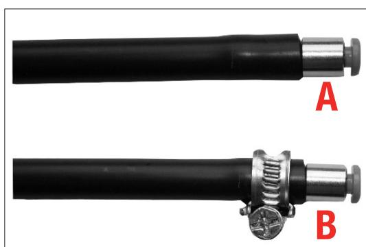
Stecken Sie den Verbindungsnißel auf das eine Ende des schwarzen Schlauchs (s. Abb. A). Danach bringen Sie eine Schlauchschelle am Schlauch an und ziehen diese mit einem Kreuzschlitzschraubenzieher fest, so dass der Schlauch und der Verbindungsnißel fest miteinander verbunden sind (s. Abb. B).
