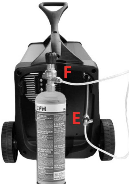
**(DE)** Verbinden Sie das eine Ende des durchsichtigen Schlauches mit dem Verbindungsnißel am schwarzen Schlauch (s. Abb. E).
