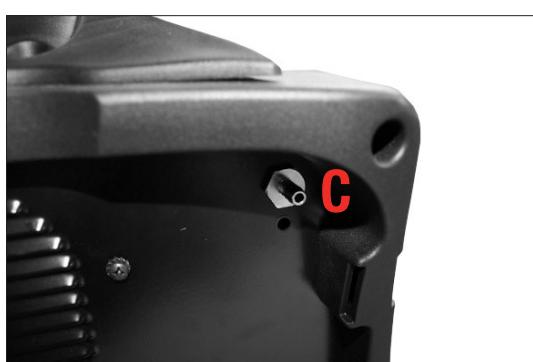
Stecken Sie das Schlauchende auf den Nippel (s. Abb. C) am Schutzgasschweißgerät SSG 145 (CFH-No. 52860) und bringen Sie die zweite Schlauchschelle so an, dass sich der Schlauch vom Nippel nicht mehr lösen kann (s. Abb. D).
