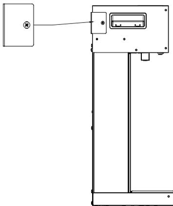
**2.1B** Entscheiden Sie sich für eine stabile Wand und montieren Sie die Montageleiste in der Position, in der Sie den Elektrokaamin aufhängen möchten. Markieren Sie nach dem Ausrichten der Halterung, die 5 Bohrlöcher an der Wand. Bohren Sie die 5 Bohrlöcher für die passenden Dübelgröße, welche Sie zur Montage verwenden möchten.
