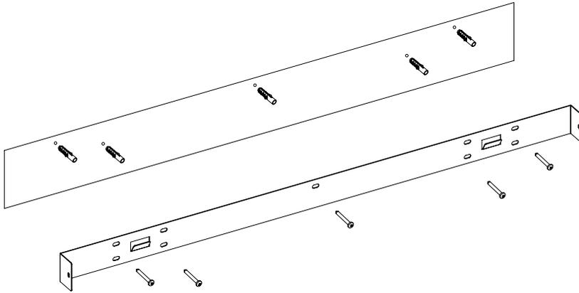
**2.1D** Za pomocą czterech śrub ST4 x 8 przymocuj wsporniki o kształcie L do podstawy kominka. Zawieś kominek na zamocowaniu i zaznacz na ścianie dwa miejsca na otwory dla wsporników w kształcie L. Następnie zdejmij kominek. Wywierć dwa otwory wiertłem o grubości 8 mm w zaznaczonych miejscach. Na końcu użyj plastikowych kołków. Za pomocą dwóch śrub ST4 x 8 przymocuj kominek do zamocowania. Za pomocą dwóch śrub ST5 x 40 przymocuj wsporniki o kształcie L do ściany.
