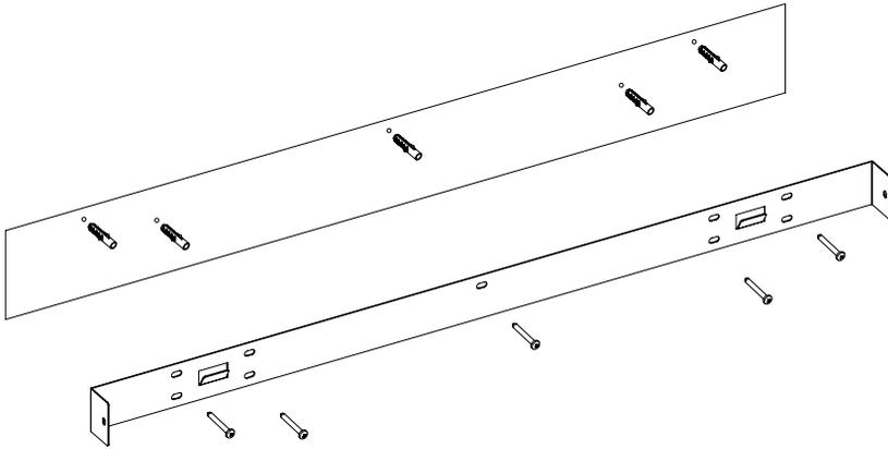
**2.1D** Utilice cuatro tornillos ST4 x 8 para fijar los soportes en L a la placa base de la chimenea. Cuelgue la chimenea en los soportes y marque los dos orificios de los soportes en L en la pared. Retire la chimenea. Taladre dos orificios con una broca de 8 mm en los puntos marcados. Después, inserte los tacos de plástico. Fije la chimenea al soporte con dos tornillos ST4 x 8. Utilice 2 tornillos ST5 x 40 para fijar los soportes en L a la pared.
