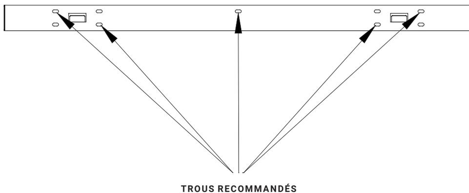
**2.1C** Insérez les chevilles en plastique dans les 5 trous de forage. Fixez ensuite la barre de montage au mur avec 5 vis ST5 x 40.
