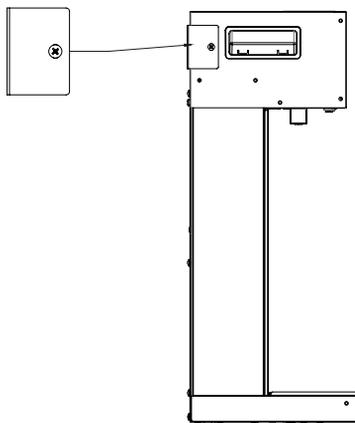
**2.1B** Wybierz stabilną ścianę i zamontuj listwę montażową w miejscu, w którym chcesz zawiesić kominek elektryczny. Zaznacz 5 miejsc do wywiercenia otworów w ścianie, po wcześniejszym wyrównaniu zamocowania. Wywierć 5 otworów o rozmiarze kołków, których chcesz użyć do montażu.
