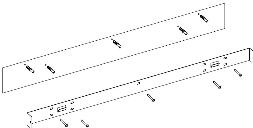
**2.1D** Utilisez quatre vis ST4 x 8 pour fixer les supports en L sur la plaque de base de la cheminée. Accrochez la cheminée sur les supports et marquez les deux trous des supports en L sur le mur. Reposez ensuite la cheminée. Percez deux trous avec une mèche de 8 mm aux endroits marqués. Utilisez ensuite les chevilles en plastique. Fixez la cheminée au support à l'aide de deux vis ST4 x 8. Utilisez 2 vis ST5 x 40 pour fixer les supports en L au mur.
